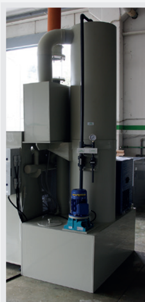
Fumes Scrubber Torre di lavaggio fumi (ITALIA)
